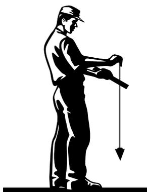
下げ墨…柱などの傾きを見るために、大工が墨糸を垂直にたらし
